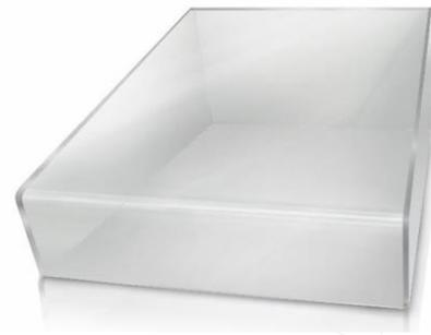
**Wassertank:** Der temperaturgeregelte Wassertank hat die gleichen Abmessungen der Plexiglas-Abdeckung und gestattet das Verdunsten des Wassers auf der gesamten Oberfläche genau unter dem Prüfling (entsprechend Anforderung laut BMW GS 94011-4).
