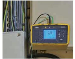
Gehäuse mit Magnethalterung.
